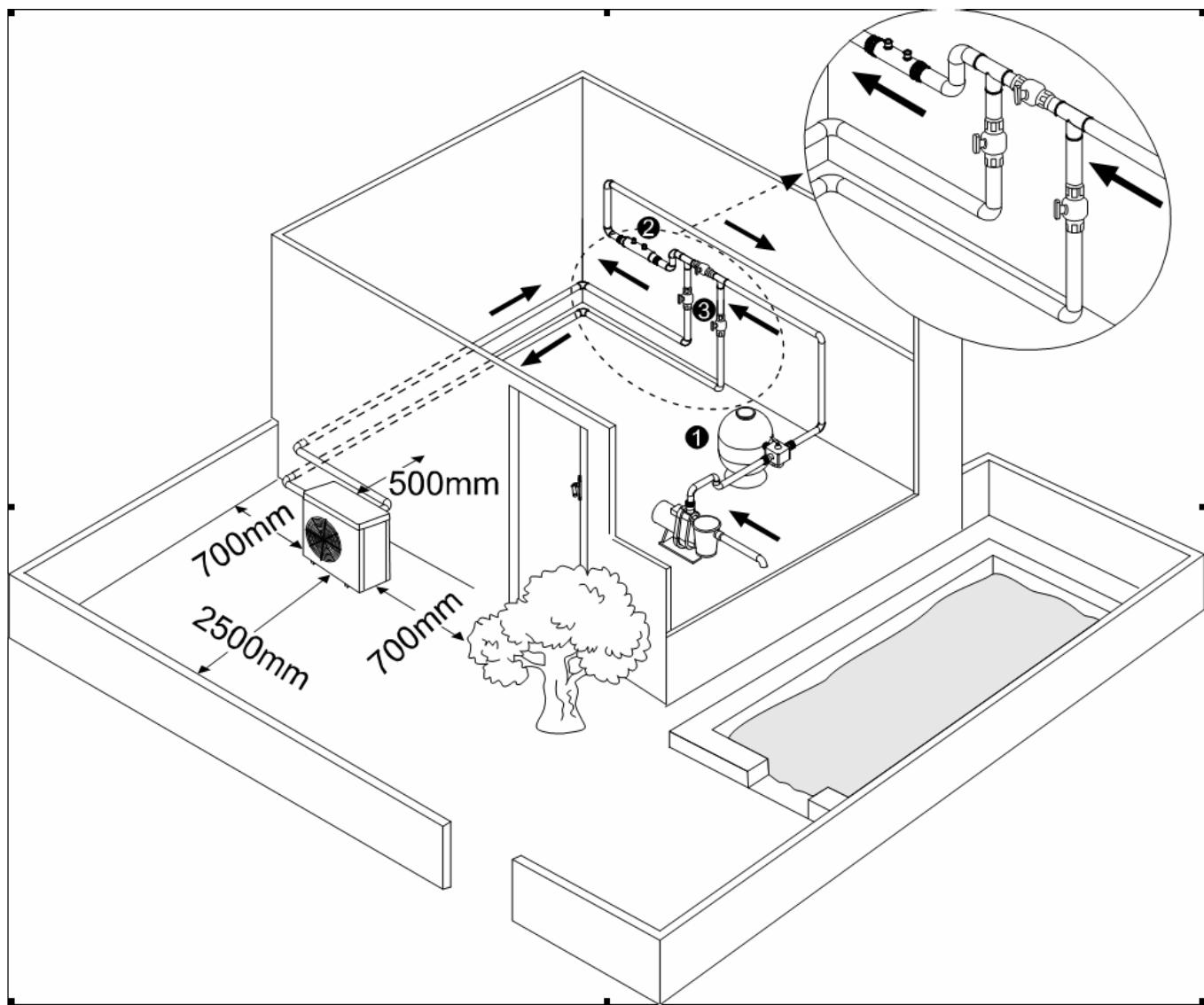
Plus besoin d'ajuster de bypass externe lors de l'installation, des vannes d'isolation pour l'hiver suffisent
