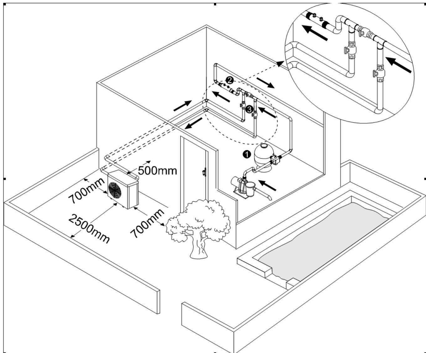
Plus besoin d'ajuster de bypass externe lors de l'installation, des vannes d'isolement pour l'hiver suffisent
