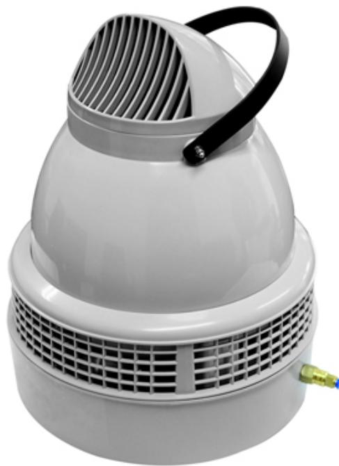
Livré avec 2 mètres de flexible d'alimentation en eau et un raccord ¼" (8/13mm) Mâle, livré avec son câble électrique 1,6 m avec prise, le VAPADISC 707 MAX fonctionne en tout-ou-rien avec un hygrostat mécanique ou un coffret de régulation électronique de l'humidité relative.
