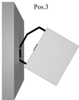
Le support mural permet d'obtenir 3 différentes positions horizontales par rapport au plan de montage mur) :
