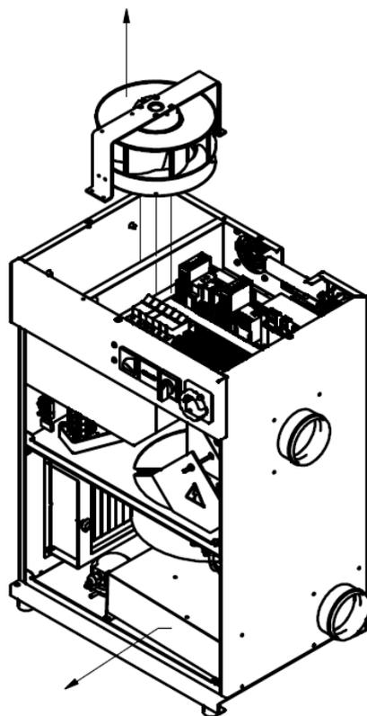
**Remplacement de la platine électrique**
