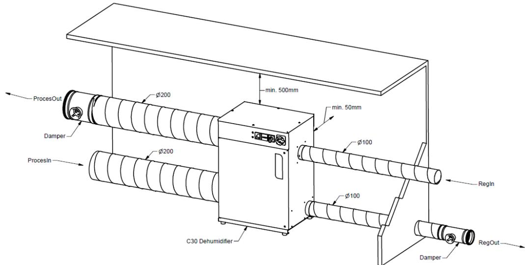
Si une canalisation descendante n'est pas possible, percer un trou d'un diamètre de 6 mm dans la partie inférieure du conduit pour permettre l'évacuation d'éventuelles accumulations d'eau.
