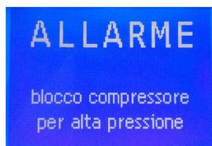
A gauche, un exemple d'affichage d'alarme : le composant en alarme ou le type d'alarme est indiqué en bas ; dans cet exemple, le compresseur haute pression est en alarme. Cet écran doit être signalé au support technique en cas d'alarme.
