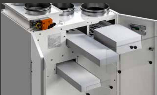
Filtres G2 standard ou F6 en option, placés à la fois dans le flux d'alimentation et d'admission de l'air extérieur. La capacité du filtre standard est de 70 % (ISO Coarse)(G2), mais il est également possible d'installer un filtre ISO ePM10 de 60 %.
