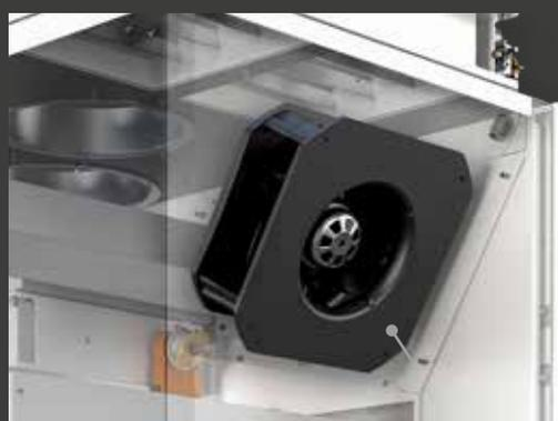
Ventilateurs EC à pales dorsales directement couplés à des moteurs sans balais régulés par un signal 0/10 volts. Ils garantissent une faible consommation d'énergie et une faible puissance sonore émise.
