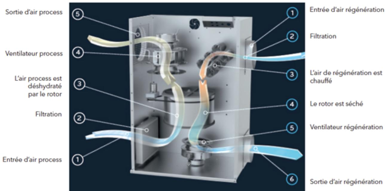
L'air process (air à traiter) traverse la roue en rotation permanente, celle-ci retient l'humidité contenue dans l'air. Un flux d'air chauffé par résistances électriques, dit air de régénération, est injecté dans la roue en sens opposé. Cet air chaud évapore l'eau contenue dans la roue puis est évacué de l'appareil vers l'extérieur. Chacun des deux flux possède son propre ventilateur.
