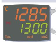
Process value (PV): Utilisé pour afficher la valeur du processus, l'étiquette des paramètres, des alarmes et des fonctions.
