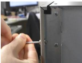
7. Desserrer les vis du couvercle de l'échangeur de chaleur et retirer le couvercle.
