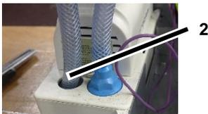
11. Souffler soigneusement l'appareil à l'air comprimé. Veiller à ce que tous les composants soient nettoyés.
