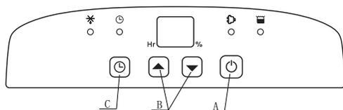
A. "ON/OFF": Utiliser pour mettre en marche ou arrêter l'appareil.
