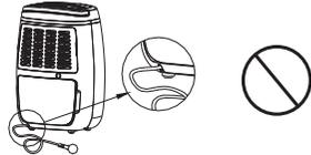
Cet appareil est équipé d'une prise électrique spécifique. Ne pas utiliser un autre raccordement ou multiprise
