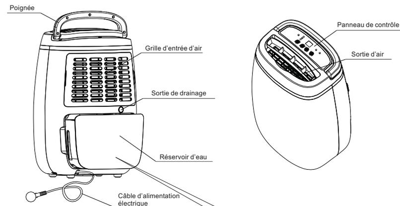
Il peut y avoir un peu d'eau résiduelle dans un appareil neuf, ceci est dû aux essais après fabrication, pas un dysfonctionnement quelconque
