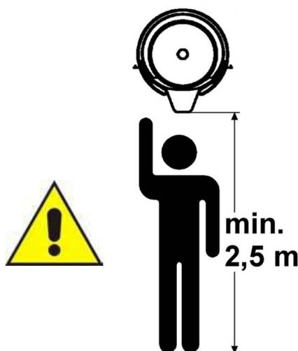
**Lors de l'installation de la machine, respectez les distances de sécurité de la norme UNI EN ISO 13857/2008.**
