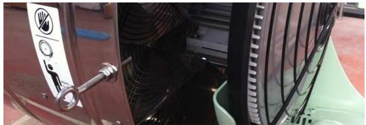
**Utiliser les crochets fournis pour installer et fixer solidement l'appareil**
