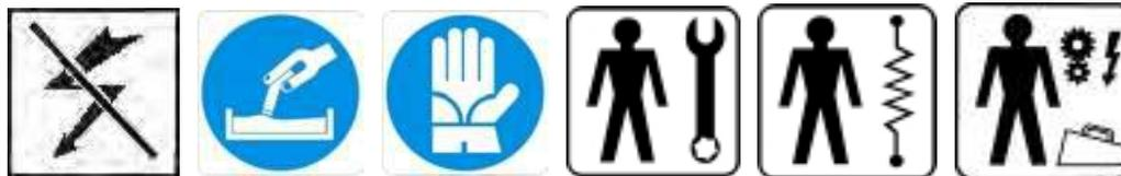
**Avant toute opération de maintenance, isoler l'appareil de l'alimentation électrique et couper l'alimentation en eau !**
