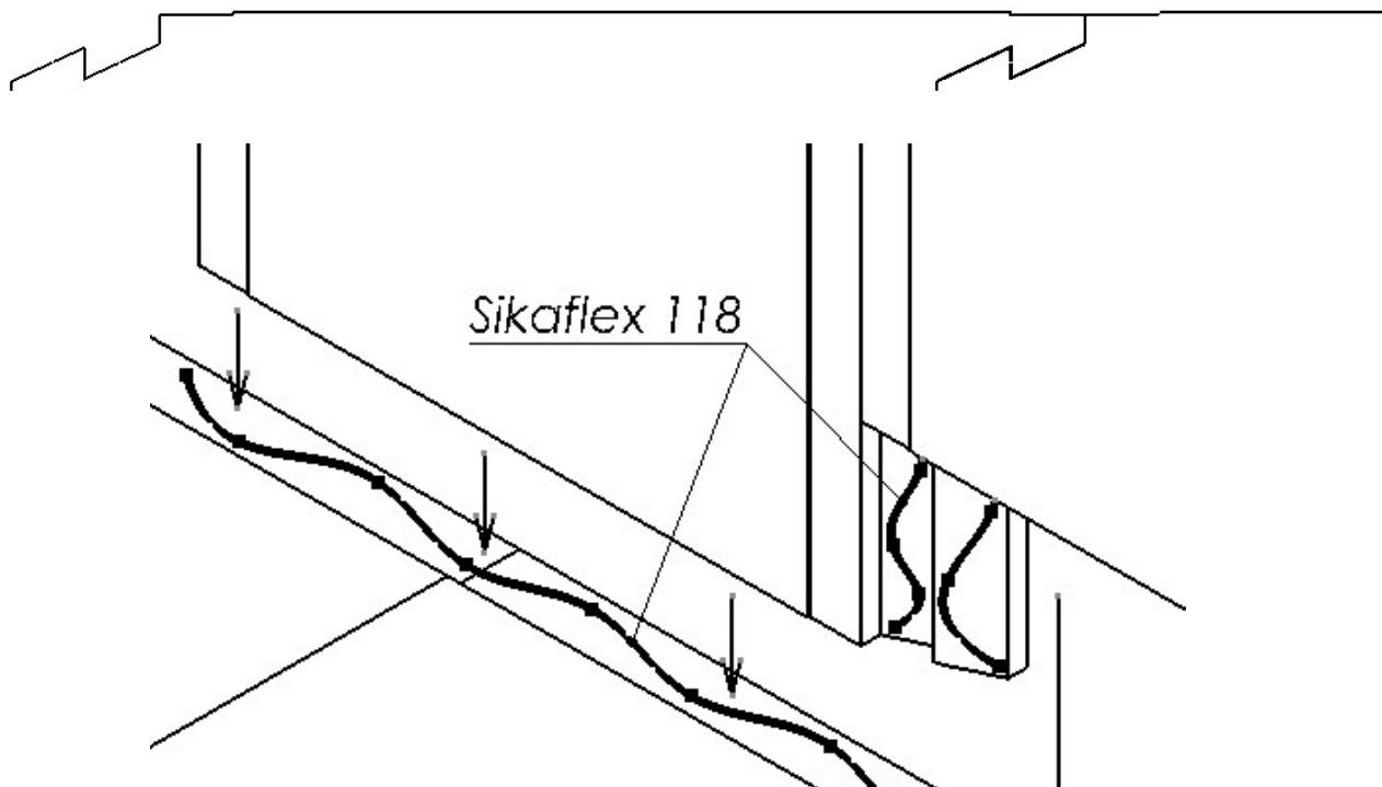
Lorsque les murs sont assemblés, prenez des plots en plastique et placez-les centrés sur le joint aux extrémités et à chaque 500 mm.
