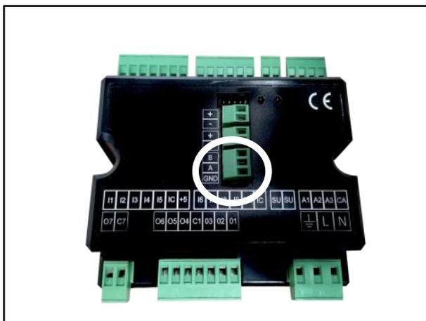
Utiliser, pour le branchement de tout le réseau Modbus, un câble CEAM Y08761 ou équivalent.
