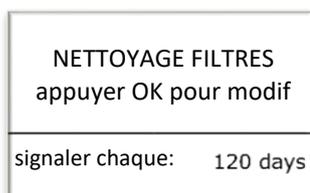
Permet de modifier le timer qui signale le nettoyage des filtres
