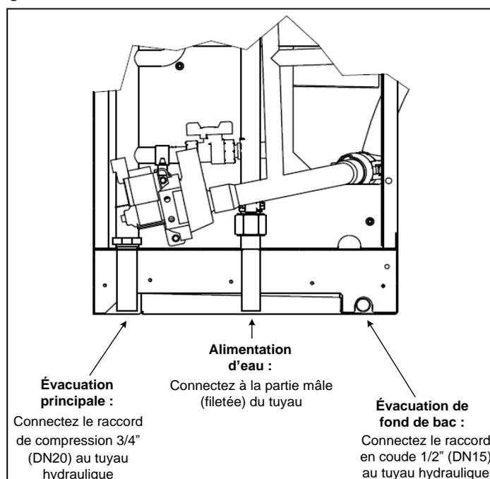
Illustration 31 - Raccordement d'alimentation et d'évacuation d'eau
