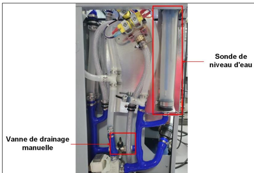
**Étape 3.** La sonde de niveau d'eau va ensuite commencer à se remplir jusqu'à temps que le niveau atteint le capteur résistif inférieur. L'opération de remplissage automatique peut être arrêter à n'importe quel moment en appuyant et maintenant sur Enter ✓ pendant 3 secondes.
