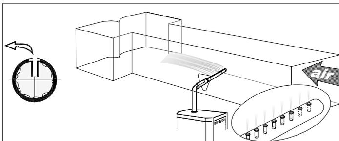
Illustration 13 - Distributeur S.A.M. dans conduit horizontal
