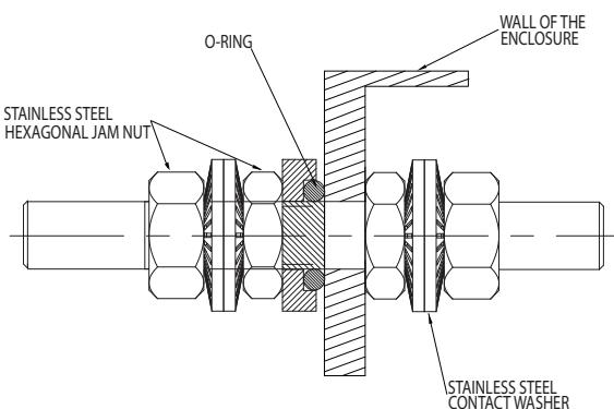
Percer trou Ø 8,5 / 9 mm pour terre traversante, sur l'un des côtés. Foret HSS coupe acier, 5% cobalt
