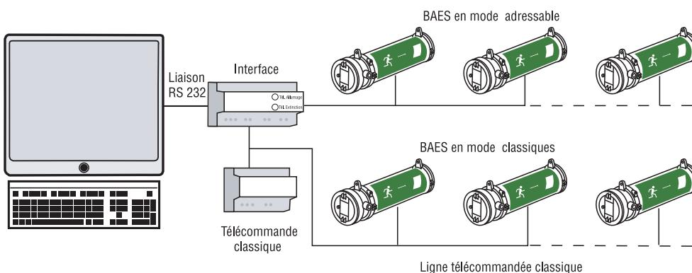
**IMPORTANT : derrière le boîtier d'interface, il ne doit y avoir que des blocs de la série URAVISION en mode "adressable"**
