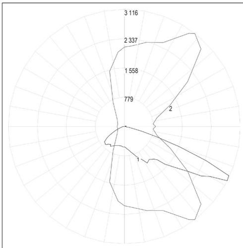
Candela maximale = 3116,4 située à l'angle horizontal = 52,5, à l'angle vertical = 62,5
