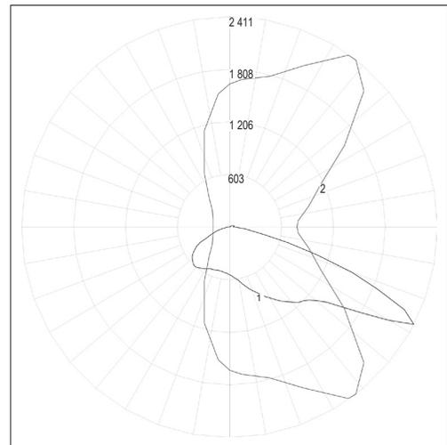
Candela maximale = 2411,15 située à l'angle horizontal = 52,5, à l'angle vertical = 62,5
