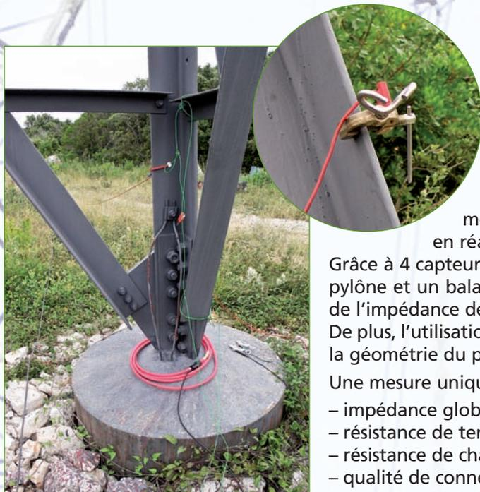
Le C.A 6472, associé au C.A 6474, unité de traitement vectoriel, offre la possibilité de mesurer la résistance de terre d'un pylône même si celui-ci appartient à un réseau de terre en parallèle, en réalisant une mesure sélective du pylône considéré.
