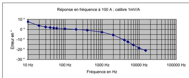
(1) Conditions de référence : 23 °C ± 3 °K, 20 % à 75 % HR, signal sinusoïdal de fréquence 48 à 65 Hz, facteur de distorsion < 1 %, absence de composante continue, champ magnétique extérieur < 40 A/m, absence de champ magnétique alternatif, absence de conducteur extérieur parcouru par un courant, conducteur mesuré centré, impédance de charge ≥ 10 MΩ / ≤ 100 pF.
