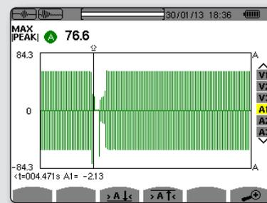
La mesure de l'inrush est réalisée sur une durée de 10 minutes. Une fois le mode d'acquisition choisi, RMS ou crête, le Qualistar assure la capture complète.
