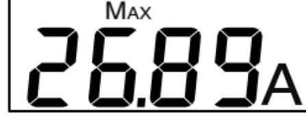
Das Symbol **MAX** wird angezeigt und nach einigen Sekunden beginnt das Gerät mit den Messungen.
