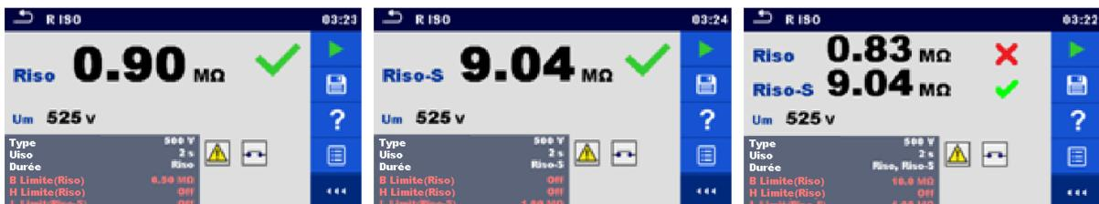
Figure 6.39 : Exemples de résultats de mesure de résistance d'isolement
