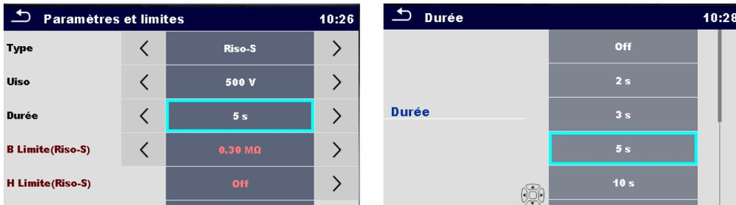
Figure 6.3 : Écrans dans le menu pour régler les paramètres et limites de tests individuels
