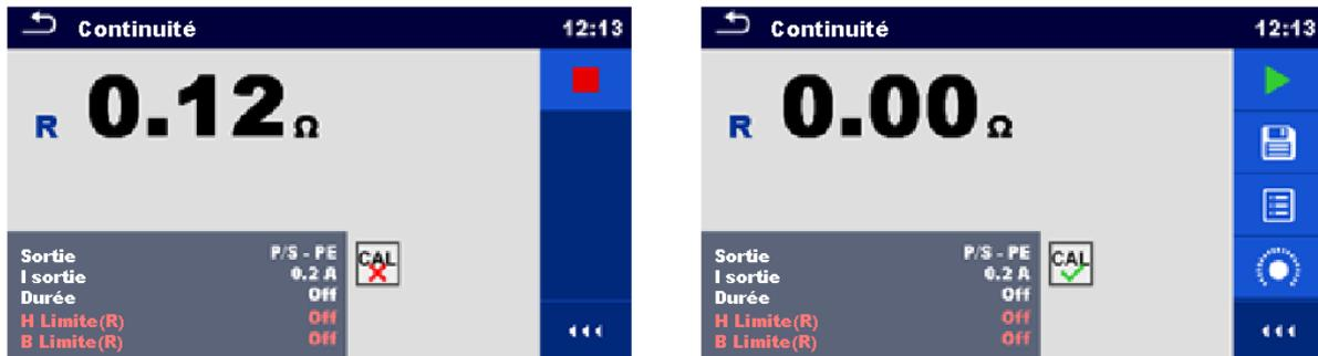
Figure 6.21 : Résultat non compensé et compensé
