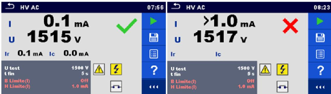
Figure 6.24 : Exemples de résultats de mesure HT AC
