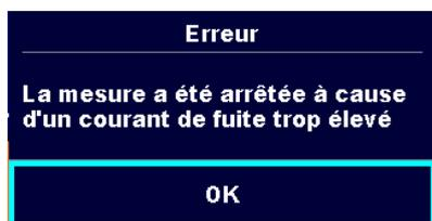
Le courant de fuite mesuré ( $I_{diff}$ ,  $I_{pe}$ ,  $I_{touch}$ ) était supérieur à 20 mA. La mesure a été annulée. Appuyez sur **OK** pour continuer.
