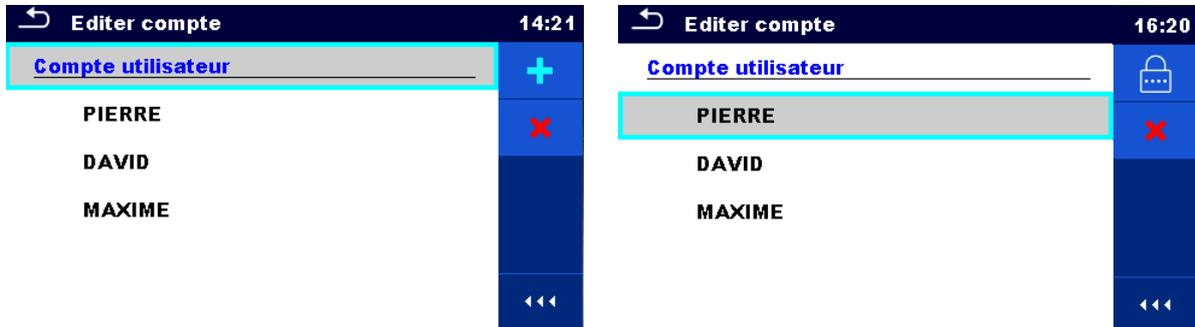
Figure 4.8: Écran Modifier comptes - liste des utilisateurs sur la gauche, utilisateur sélectionné sur la droite
