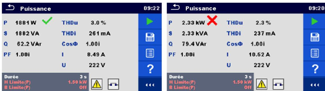
Figure 6.56 : Exemples de résultats de mesure de Puissance
