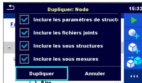
Figure 5.12 : Menu Clonage de l'objet structurel
