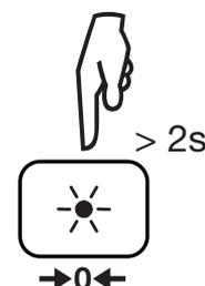
L'affichage passe à zéro et le symbole  $\rightarrow 0 \leftarrow$  s'affiche. Pour toutes les mesures de continuité, la résistance des cordons sera systématiquement soustraite. Si la résistance des cordons est > 10  $\Omega$ , la compensation ne se fait pas.
