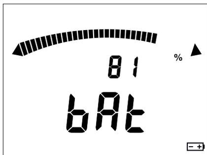
Si la tension pile est trop basse pour assurer un fonctionnement correct de l'appareil, il le signale.
