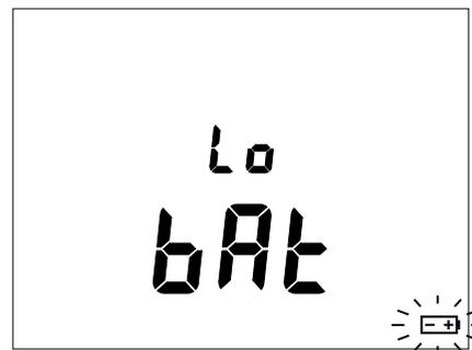
Il faut alors impérativement remplacer les piles (voir § 5.2), l'indication de l'autonomie n'étant plus fiable.
