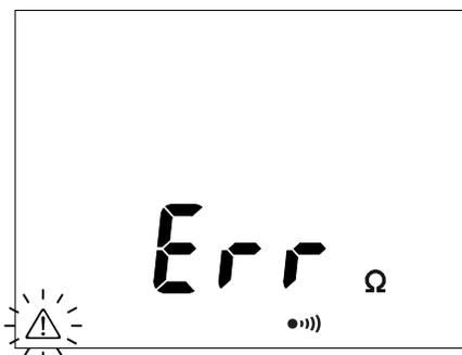
Pendant la mesure de continuité, de résistance ou de capacité, si l'appareil détecte une tension extérieure supérieure à 15 V (alternative ou continue), il interrompt la mesure et affiche l'écran ci-contre.
