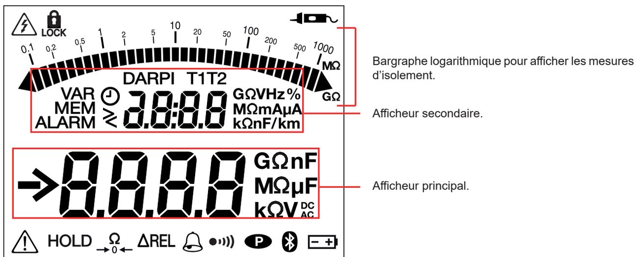
Lorsque la mesure est inférieure au minimum, l'appareil affiche - - - - .
