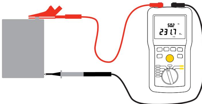
L'appareil affiche la tension présente sur les bornes. Il détecte si la tension est alternative ou continue. Pour le CA 6532, dans le cas d'une tension alternative, l'appareil affiche aussi la fréquence.
