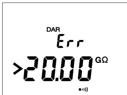
Pour le CA 6532, si cela survient pendant une mesure de DAR ou de PI, l'appareil interrompt la mesure et affiche l'écran ci-contre.
