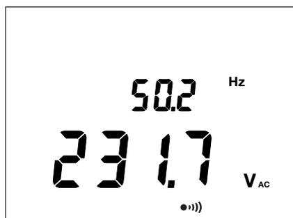
Sur les positions **MΩ**, le symbole
