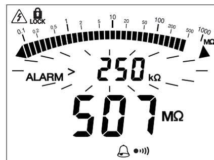
Dans l'exemple ci-dessus, l'utilisateur peut ainsi contrôler que sa mesure de continuité est bien inférieure à 2 Ω, juste en écoutant et sans regarder l'afficheur. Il peut contrôler de la même manière la qualité de l'isolement.
