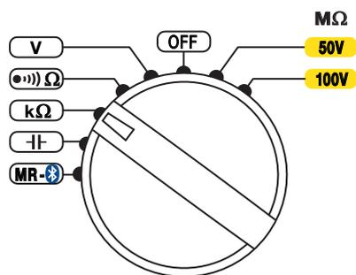
Comme pour une mesure de continuité, reliez le dispositif à tester aux bornes de l'appareil. Le dispositif à tester ne doit pas être sous tension (voir § 2.4.3).
