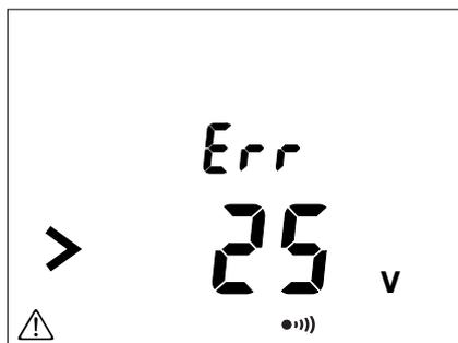
Avant la mesure d'isolement, l'appareil est en mesure de tension. Si y a une tension présente sur les bornes supérieure à 25 V et que vous essayez quand même de faire une mesure, l'appareil le signale.
