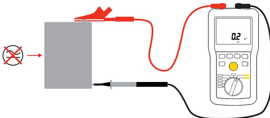
Appuyez sur le bouton **TEST** et maintenez l'appui jusqu'à ce que la mesure affichée soit stable. Si une tension supérieure à 25 V est détectée, l'appui sur le bouton **TEST** est inactif.
