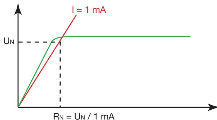
La gamme de fonctionnement selon l'IEC 61557 est de  $100 \text{ k}\Omega$  à  $2 \text{ G}\Omega$ . (voir § 4.4).
