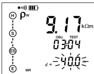
Il est ultérieurement possible d'écraser des valeurs déjà mémorisées par de nouvelles avec la même distance  $d$  ou même d'ajouter de nouveaux résultats avec d'autres valeurs pour la distance  $d$  sous condition que tous les autres paramètres de la mesure soient identiques.
