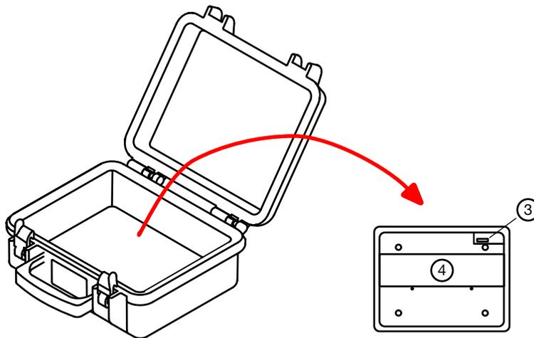
4. Remettez la trappe batterie en place et serrez les vis.
