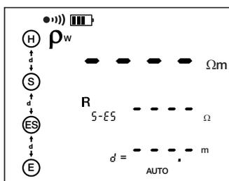
Programmez la distance d et démarrez la mesure en appuyant sur le bouton START/STOP.
