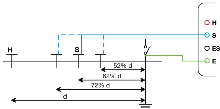
Les 3 résultats de mesure doivent être les mêmes à quelques % près. Dans ce cas la mesure est valide.
