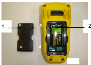
Figure 6 : accès à la pile
