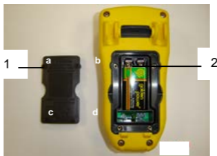
Figura 6 : acceso a la pila
