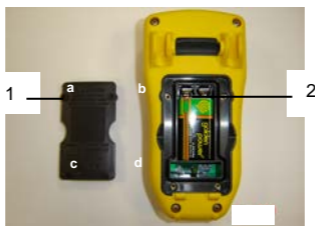
Figura 6 : accesso alla pila
