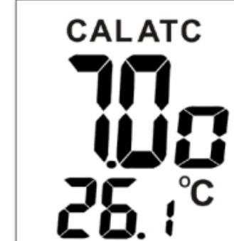
Si el valor de la solución tampón no es exactamente 7,00, usted lo puede cambiar manteniendo pulsada la tecla **HOLD**. Así, el valor cambiará a 7,01 y luego a 7,02, etc. Después de 7,50, el valor cambiará a 6,50 y luego a 6,51, etc.
