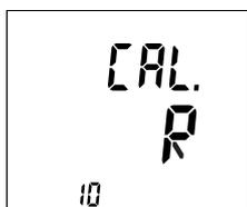
Pour entrer dans la procédure d'ajustage de la mesure d'impédance, appuyez sur la touche ► pendant plus de 3 secondes.
