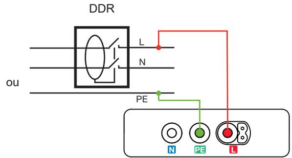
L'appareil vérifie tout d'abord que la tension entre les bornes **L** et **PE**, est correcte. Dans ce cas le symbole
