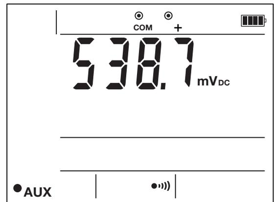
Convertissez ensuite la tension affichée en courant en utilisant le rapport de transformation (RT) du capteur :
