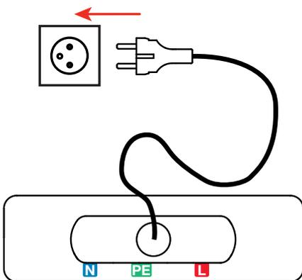
La mesure s'affiche. L'appareil indique qu'il effectue la mesure entre les bornes L et N. Il est donc possible d'utiliser 2 cordons pour faire la mesure.
