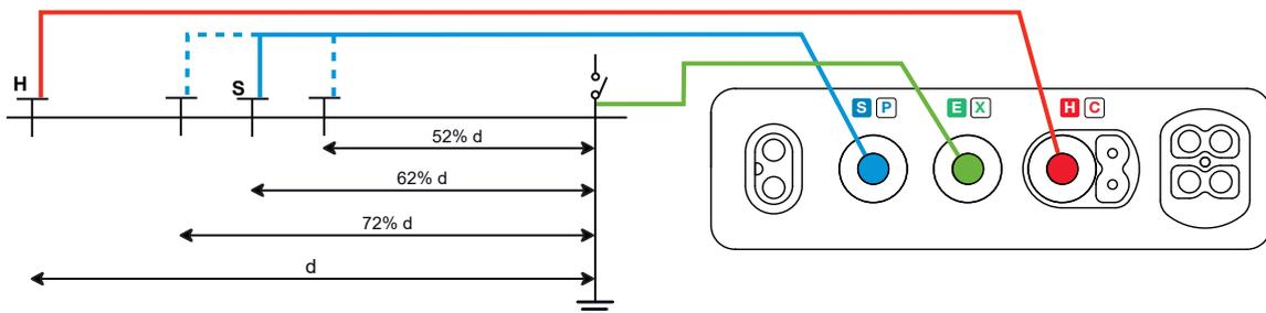
Les 3 résultats de mesure doivent être les mêmes à quelques % près. Dans ce cas la mesure est valide. Sinon, cela signifie que le piquet S se trouve dans la zone d'influence de la prise de terre.
