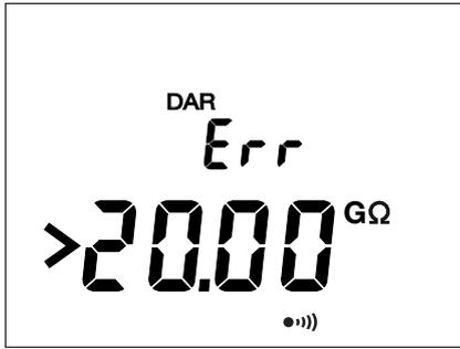
Pour le C.A6532, si cela survient pendant une mesure de DAR ou de PI, l'appareil interrompt la mesure et affiche l'écran ci-contre.
