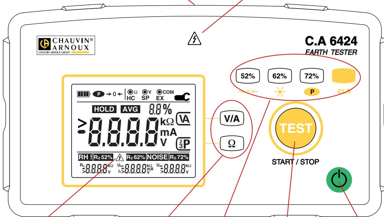
Afficheur LCD rétroéclairé.
