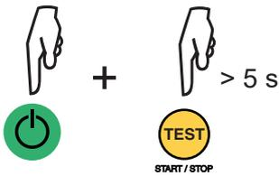
Pour cela, maintenez appuyés les boutons **Marche / Arrêt** et **TEST** au démarrage pendant plus de 5 secondes, les noms des bornes H, S, E deviennent C, P, X. Cette information est conservée même si l'appareil est éteint.
