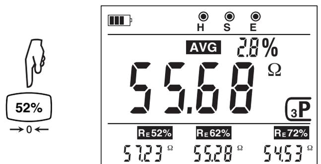
L'appareil calcule aussitôt la moyenne des 3 mesures ainsi que la variation en % entre la valeur la plus faible et la valeur la plus élevée. Pour que la mesure soit valide, la variation ne doit pas dépasser 5%.
