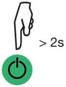
Faites un appui long sur le bouton **Marche/Arrêt** pour allumer l'appareil. Il indique qu'il est en mesure résistance en affichant **2P**.
