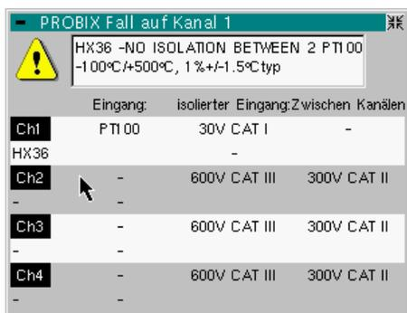
Die «°C» Messungen stehen 30" nach dem Anschluss des HX0036 zur Verfügung, nach Kalibrierungsphase. Während dieser Phase wird die folgende Meldung angezeigt:
