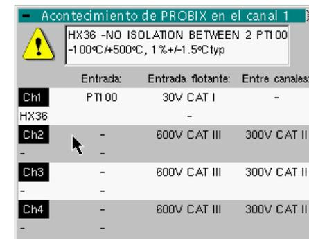
La medida «°C» es disponible 30 seg. después de la conexión del HX0036, después de una fase de calibración. Durante esta fase, se visualiza el mensaje siguiente:
