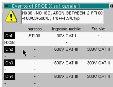
Le misure «°C» sono disponibili 30 sec. dopo il collegamento dell'HX0036 dopo la fase di calibratura. Nel corso di tale fase, viene visualizzato il seguente messaggio:
