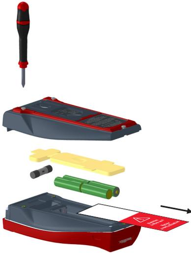
Dévissez les 3 vis cruciformes puis otez la membrane batterie.
