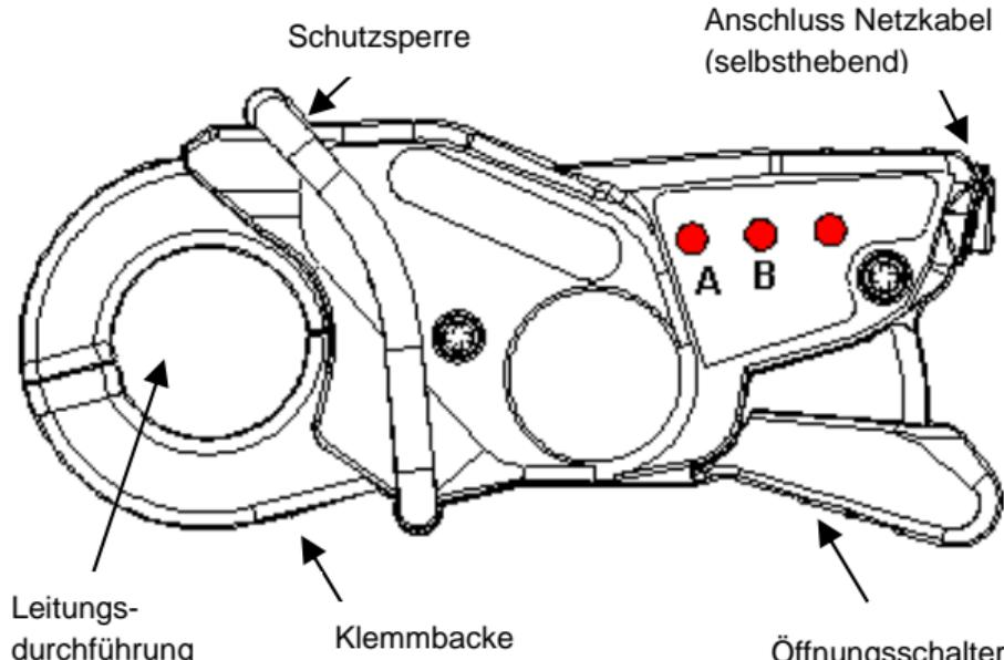
Drei Drucktasten befinden sich an den Seiten der Zange:
