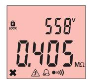
Par contre, si la mesure est inférieure au seuil, l'appareil émet un signal sonore continu, le rétroéclairage s'allume en rouge et le symbole s'affiche.
