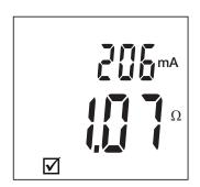
Pour vous assurer qu'il n'y a pas de tension, faites une mesure de tension avant la mesure de continuité.
