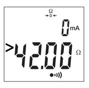
Si l'afficheur indique > 42.00  $\Omega$ , c'est que le fusible a fondu et qu'il faut le remplacer.
