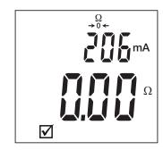
La compensation des cordons est aussi utilisée en mesure de résistance. Elle est conservée même après l'extinction de l'appareil.
