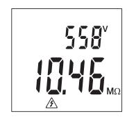
Appuyez sur le bouton **TEST** et maintenez-le appuyé jusqu'à ce que la mesure soit stable. Le symbole indique que l'appareil génère une tension dangereuse.
