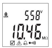
Les seuils d'alarme sont programmables (voir § 3.9). Il y en a un pour chaque tension d'essai.
