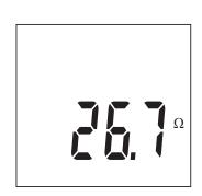
Pour vous assurer qu'il n'y a pas de tension, vous pouvez faire une mesure de tension avant la mesure de continuité. Sinon, l'appareil vous signalera la présence d'une tension.
