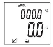
A chaque nouvelle mesure, l'appareil indique la différence entre la nouvelle mesure et la mesure de référence ainsi que l'écart en %.
