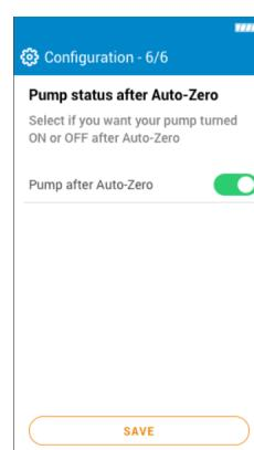
Sélectionner si la pompe doit être activée ou désactivée après l'autozéro en appuyant sur OK puis aller sur "Enregistrer" ..
