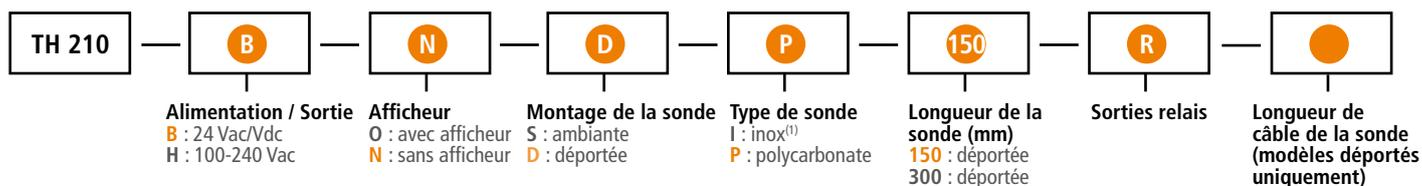
Exemple : TH 210 – BNDP150 – R : Capteur/transmetteur d'hygrométrie et température, alimentation 24 Vac/Vdc, sans afficheur, avec sonde déportée en polycarbonate de longueur 150 mm, câble longueur 2 m et sorties relais.
