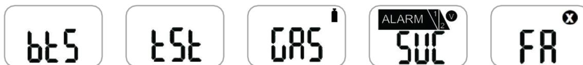
Avant de démarrer le test au gaz, il faut régler l'intervalle de test. Lorsque cet intervalle est écoulé, le message « BTS » clignote. Maintenir le bouton appuyé pendant 3 secondes. Ensuite, le message « TST » s'affiche pendant 45 secondes (appuyez sur le bouton pendant 1 seconde pour annuler). Effectuer un test de gaz dans les 45 secondes. Si aucun test n'est effectué, le message BTS recommence à clignoter.
