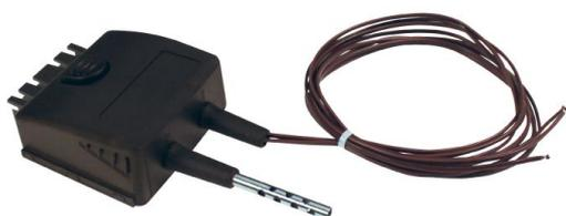
Permet de calculer le coefficient U grâce à la moyenne de 3 sondes de température de contact, la mesure de la température ambiante en thermocouple T et la mesure de la température externe (entrée manuellement ou donnée par une sonde de température RF)
