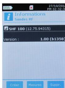
Les informations relatives à la sonde apparaissent à l'écran. A l'aide de la touche de fonction « **Mesures** » il est possible de revenir à l'écran des mesures. Il est aussi possible de supprimer la sonde RF en appuyant sur la touche de fonction « **Suppr.** ».
