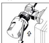
**1.** Avec un tournevis, pousser la bague vers le corps du robinet, jusqu'à la butée.
