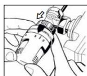
**3.** Remettre la bague en place. Le robinet n'est plus limité ni bloqué.
