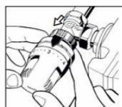
**3.** Remettre la bague en place. Le robinet est bloqué à la température sélectionnée.
