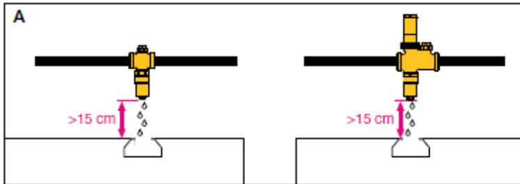
Respecter une distance de 15 cm au moins par rapport au sol (fig. A) afin d'éviter que la formation éventuelle d'une colonne de glace dans la zone située en dessous n'empêche l'écoulement de l'eau par la soupape. Diriger l'eau qui s'écoule en un point de récupération approprié.
