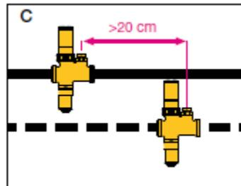
Respecter une distance d'au moins 10 cm entre les soupapes antigel (fig. B) et de 20 cm entre les soupapes antigel avec capteur d'air (fig. C).
