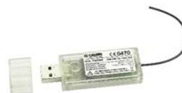
Dispositif USB/radio transmetteur + logiciel SW7200 pour la lecture et l'affichage des consommations. Communication sans fil bidirectionnelle 868,0÷868,5 MHz, 20 mW. Logiciel développé sous Microsoft® Windows.
