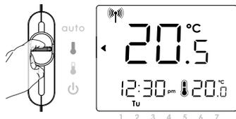
**Éco** : Mode Éco permanent. L'appareil fonctionne 24h/24 à la température Éco réglable (par défaut 16°C - voir chapitre réglage de la température Éco page 5).
