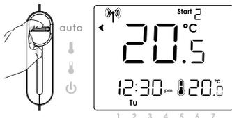
**Confort** : Mode confort permanent. L'appareil fonctionne 24h/24 à la température Confort réglée (par défaut 20°C - voir chapitre réglage de la température Confort page 5).
