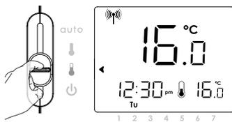
**Mise en veille** : Mode mise en veille permanent avec protection Hors-gel. L'appareil maintient 24h/24 une température de 8°C, permettant de sécuriser l'installation contre le gel. La température ambiante sera affichée.
