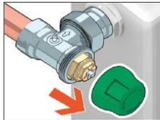
Pour effectuer le pré-réglage du débit positionner la molette de réglage prévue à cet effet. Le référencement de la position de tarage est définie par le coté plat de l'obturateur (1).
