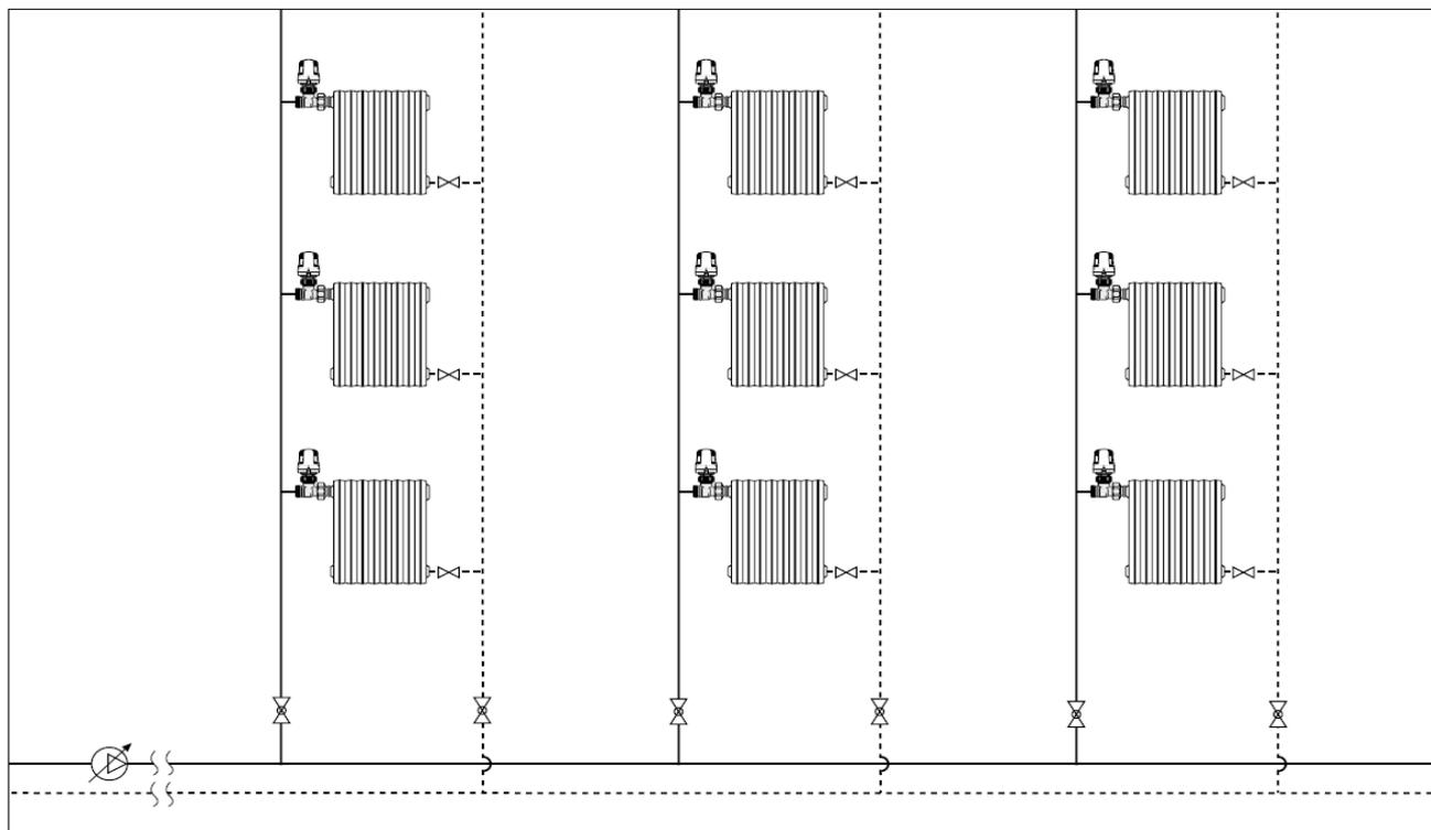
**NB :** Dans des moyennes ou grandes installations, il est conseillé d'installer des régulateurs de  $\Delta p$  en pied de colonne.
