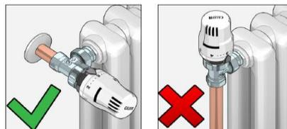
Ne pas installer les têtes thermostatiques dans des niches, derrière des tentures ni directement exposées aux rayons du soleil qui pourraient fausser les mesures.
