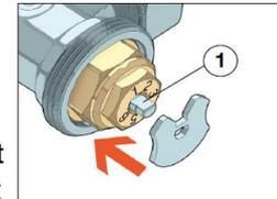
Faite une rotation pour sélectionner la position désirée.
