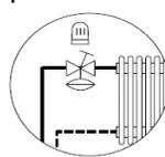
La tête thermostatique, quant à elle, permet de réguler le débit délivré au radiateur. Lorsqu'elle est ouverte à 100%, le débit délivré au radiateur correspond au débit réglé sur le robinet.
