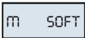
Par contre, si l'unité est réglée pour effectuer le traitement d'adoucissement, le dispositif sera en mesure de contrôler la capacité résiduelle de la cartouche installée, le volume d'eau traité et le débit.
