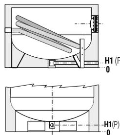
Le modèle de 1500L est équipé d'un support qui facilite la manutention et d'une tuyauterie de vidange qui permet une vidange totale
