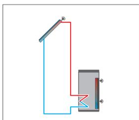
Système de chauffage solaire standard
