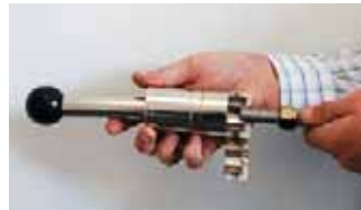
3 Ouvrir la partie mobile et positionner le tube dans l'encoche à 2 ondes de l'extrémité.
