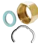
Raccords écrou tournant composés d'un écrou tournant en laiton nickelé, d'une bague inox AISI 304 et d'un joint NBR pour tubes de \varnothing 12, 16, 20 et 25 mm.
