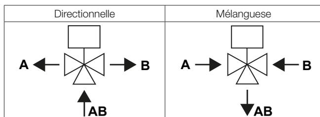
La vanne trois voies avec orifice en "T" peut être utilisée en position directionnelle (entrée commune AB et sortie A ou B) ou en position mélangeuse (entrées en A et B et sortie commune AB). Pendant la rotation de 90° de la sphère, les trois orifices AB, A et B sont reliés hydrauliquement.
