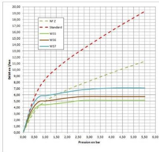
Courbe débit en fonction de la pression et comparaison entre les moussesurs NSF EPA WaterSense (WS 5, 6 ou 7), un NF classe Z et un mousseur standard
